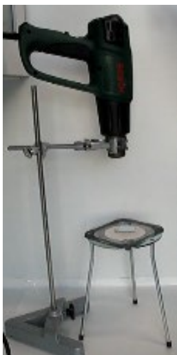
Figur 4. \text{TiO}_2 -filmen hærdes ved 450\text{ }^\circ\text{C} i 30 min under en varmpistol.
