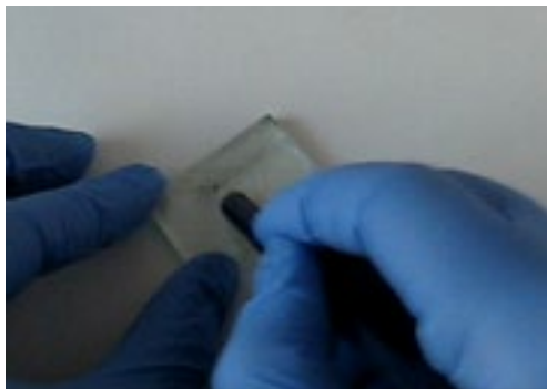
Figur 6. Fremstilling af modelektrode: Et grafit lag påføres glassets ledende side.
